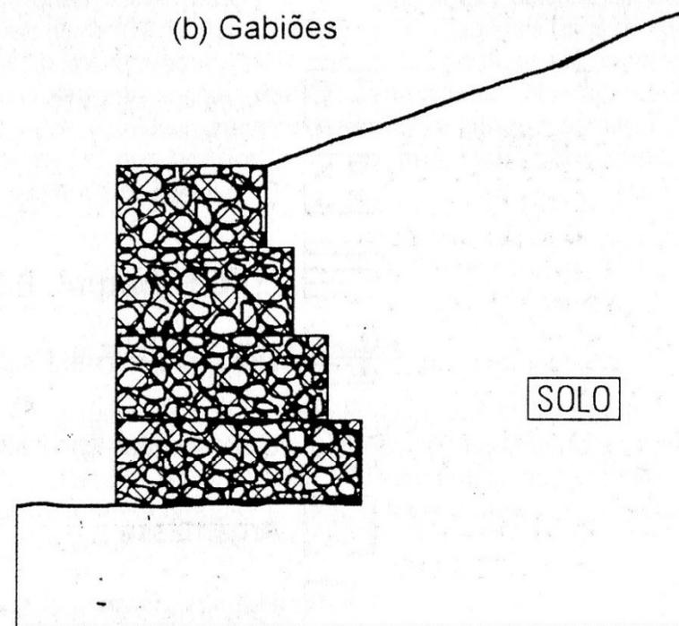
Muros de arrimo com blocos(a) e gabiões(b)
